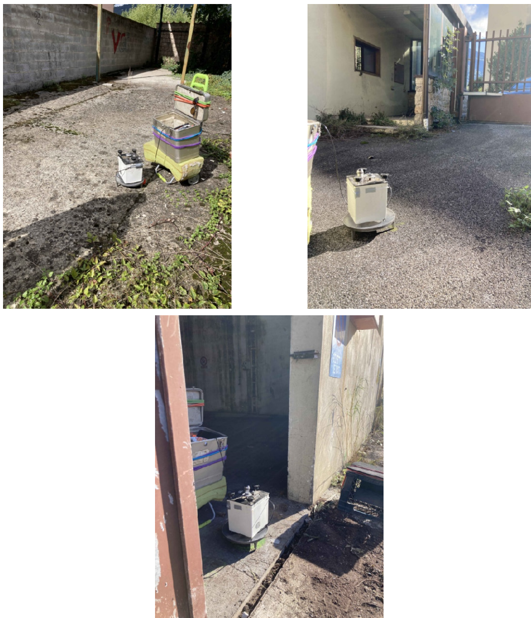
Figura 8: Gravimetro in misura su alcune stazioni di misura nell'area d'indagine
