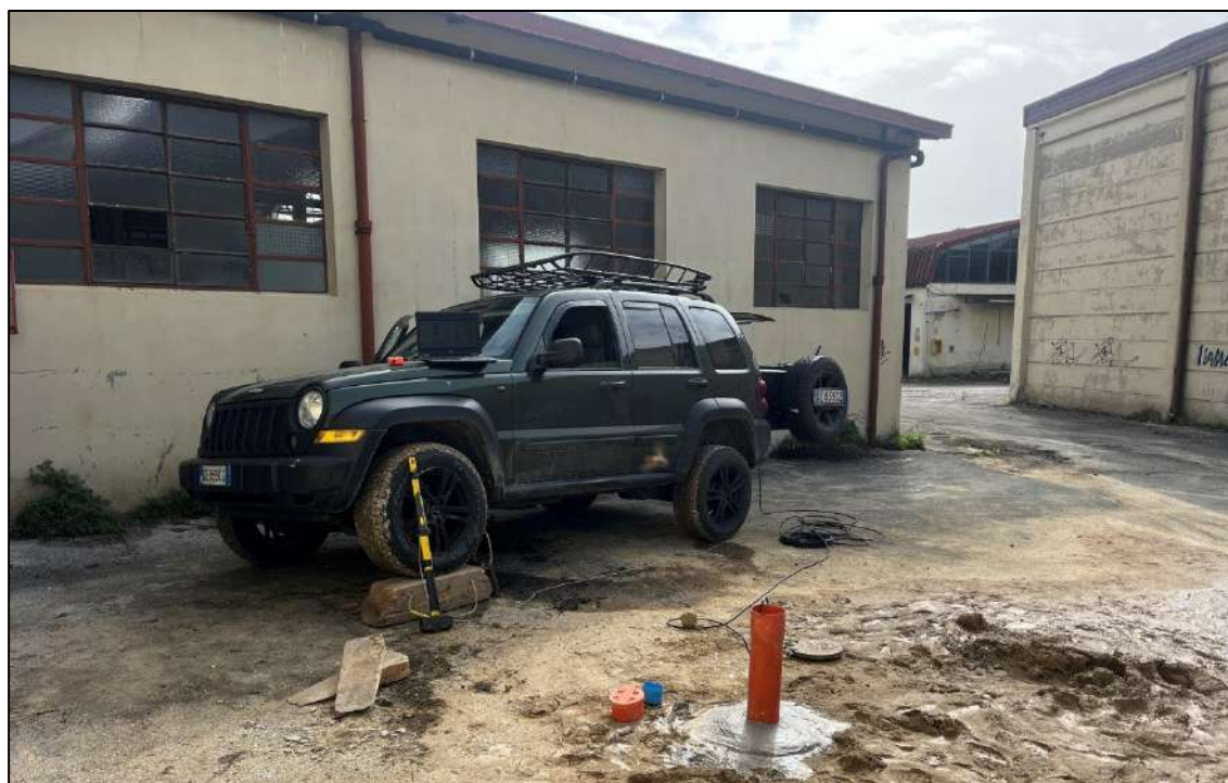
Fig. 35 Esecuzione dell'indagine di sismica a in foro tipo Down-hole
