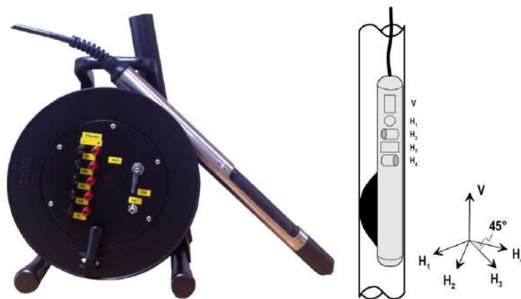
Fig. 5 Geofono da foro Geotomographie BGK5 per prove fino a 50 m. A dx lo schema di orientazione dei 5 velocimetri alloggiati nel corpo dello strumento.
