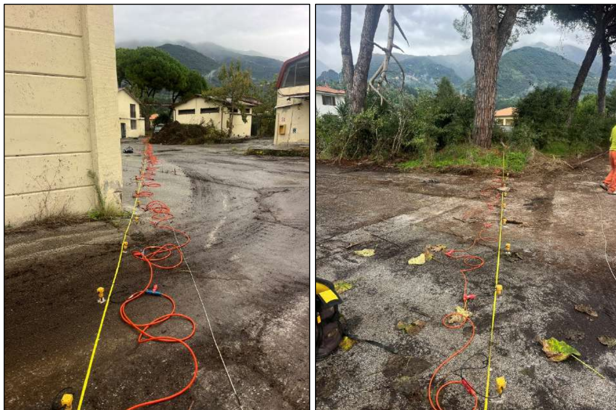
Fig. 34 Esecuzione dell'indagine di sismica a riflessione. A dx vista della linea ripresa da G3 verso centro linea. A sx viste del tratto finale foto da G60 verso G96
